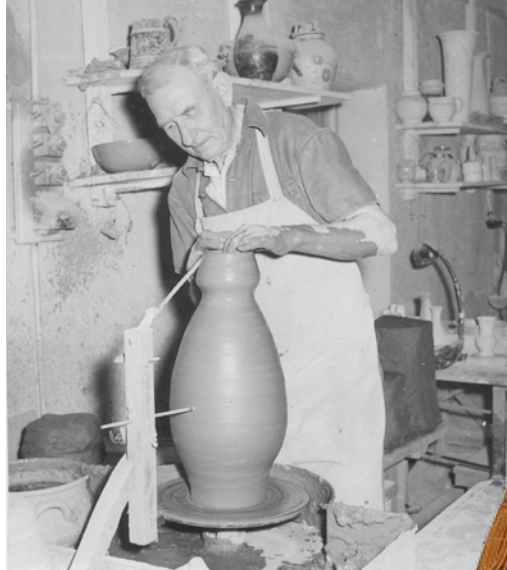
Golvvasen av Ternell tillverkades 1953-56. Drejaren Ernst Sjöberg arbetar med att forma modellen.
